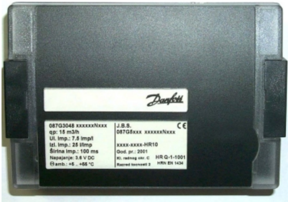
Slika 7: Zaštita prilagodnoga impulsnog sklopa mjerila protoka od neovlaštena pristupa koja se provodi nakon ovjeravanja
